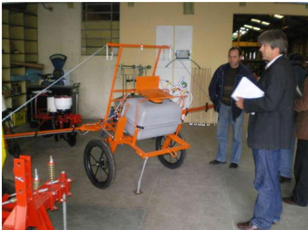
Figura 57 – Pulverizador a tração animal da NSMAFRENSE exposto em visita de integrante da FAO.
