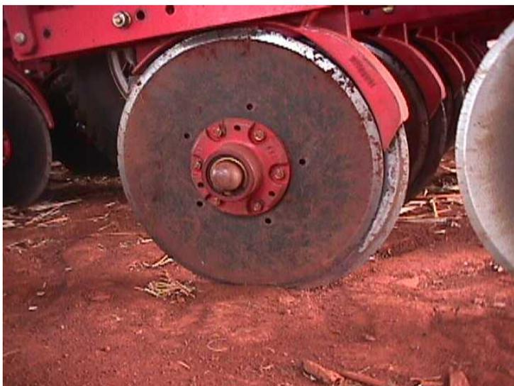
Figura 15 – Discos duplos com eixo desencontrados.
