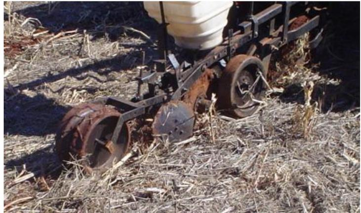
Figura 20 – Unidade de sementeira para realizar o plantio direto “invisível” e perfil do sulco de sementeira sobre palha de brachiaria.
