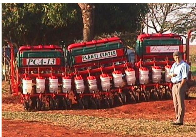
Figura 24 - Semeadora KK 7/4 com sistema de transferência de peso.
