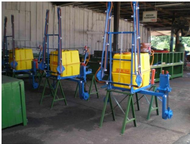
Figura 56 – Linha de montagem de pulverizadores a tração animal na TRITON.
