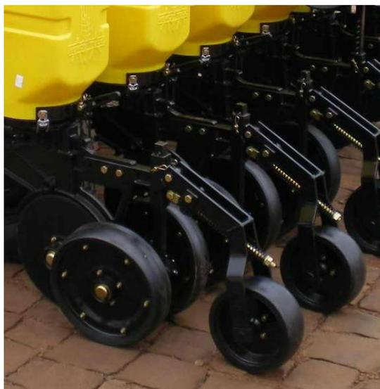
Figura 16 – Rodas de controle de profundidade em “V”.
