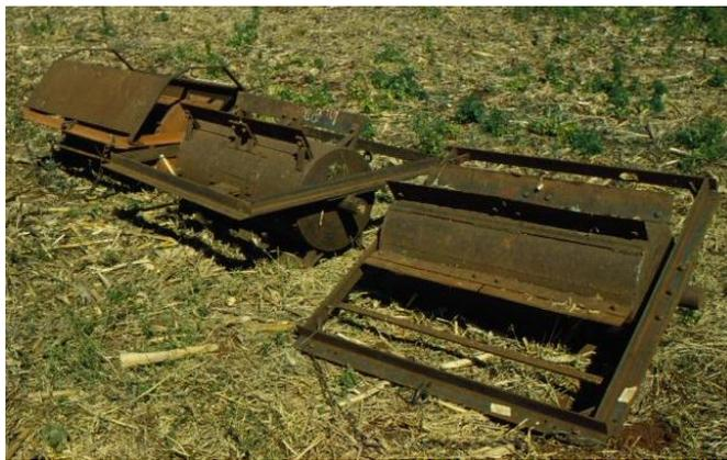
Figura 40 – Três protótipos de rolo faca a tração animal que deram origem ao rolo faca “Queixada Iapar”.
