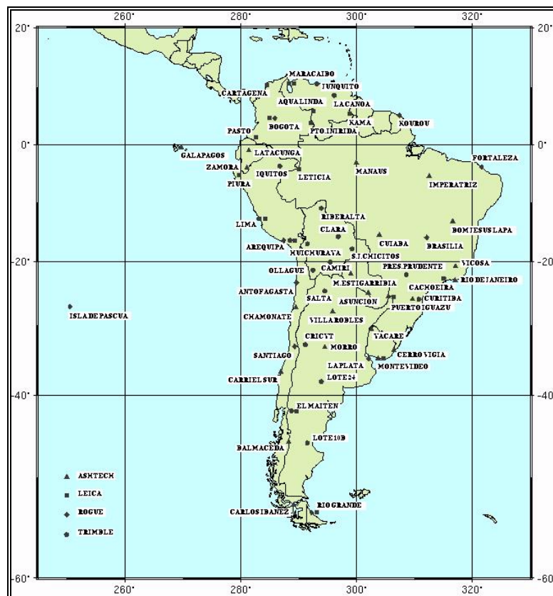
Figura 1 - Rede SIRGAS, 1995. Os diferentes símbolos representam os vários receptores GPS utilizados durante a campanha SIRGAS95
